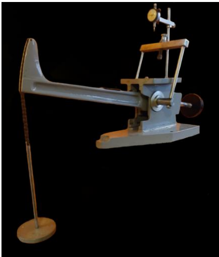
FIGURA 27.- CONSOLIDÓMETRO MECÁNICO, DE COLOR GRIS, CON BRAZO DE PALANCA 1:10, CON CADENA PARA MANTENER LA CARGA VERTICAL Y LA RELACIÓN DE CARGA APLICADA 1:10; EL CONSOLIDÓMETRO DE COLOR AZUL LA RELACIÓN DE PESO APLICADO CON EL PESO SOBRE DE LA MUESTRA ES DE 1:12.5. EN AMBOS SE TIENE EN LA PARTE POSTERIOR UN CONTRA PESO PARA ANULAR EL PESO DEL BRAZO Y MARCO DE CARGA, DE TAL MANERA QUE LA CARGA APLICADA A LA MUESTRA SEA ÚNICAMENTE LA QUE SE TIENE EN EL PORTAPESAS. ADEMÁS SE TIENE UN SOPORTE PARA COLOCAR EL EXTENSÓMETRO DE CARÁTULA.
