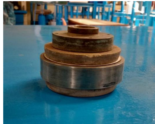
FIGURA 29.- UNA VEZ LABRADA LA PROBETA O PASTILLA DE CONSOLIDACIÓN SE PESA Y SE COLOCAN EN SUS BASES PAPEL FILTRO Y PIEDRAS POROSAS PARA PERMITIR LA SALIDA DEL AGUA DENTRO DE LA MUESTRA, POSTERIORMENTE SE MONTA EN EL CONSOLIDÓMETRO.
