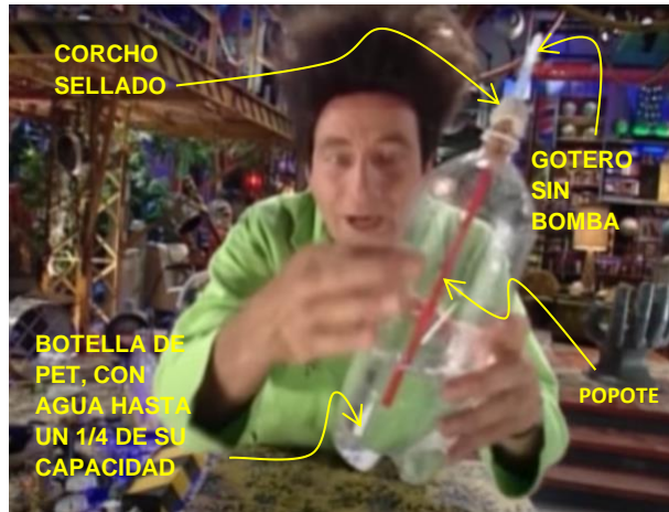
FIGURA 6.- "EQUIPO" PARA LA DEMOSTRACIÓN DE LA COMPRESIBILIDAD DEL AIRE.
