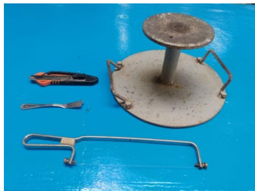
FIGURA 25.- PARTE DEL EQUIPO DE LABRADO: TORNO, ESPÁTULAS, ARCO CON LA PRIMERA CUERDA DE GUITARRA.
