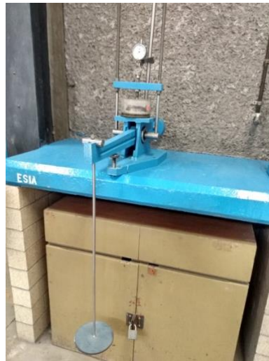
FIGURA 27.- CONSOLIDÓMETRO MECÁNICO, DE COLOR GRIS, CON BRAZO DE PALANCA 1:10, CON CADENA PARA MANTENER LA CARGA VERTICAL Y LA RELACIÓN DE CARGA APLICADA 1:10; EL CONSOLIDÓMETRO DE COLOR AZUL LA RELACIÓN DE PESO APLICADO CON EL PESO SOBRE DE LA MUESTRA ES DE 1:12.5. EN AMBOS SE TIENE EN LA PARTE POSTERIOR UN CONTRA PESO PARA ANULAR EL PESO DEL BRAZO Y MARCO DE CARGA, DE TAL MANERA QUE LA CARGA APLICADA A LA MUESTRA SEA ÚNICAMENTE LA QUE SE TIENE EN EL PORTAPESAS. ADEMÁS SE TIENE UN SOPORTE PARA COLOCAR EL EXTENSÓMETRO DE CARÁTULA.
