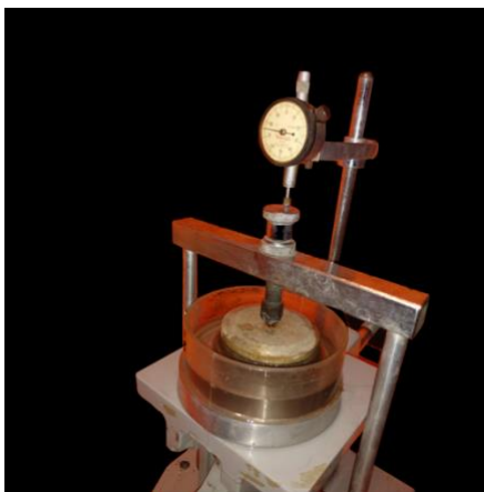
FIGURA 29.- UNA VEZ LABRADA LA PROBETA O PASTILLA DE CONSOLIDACIÓN SE PESA Y SE COLOCAN EN SUS BASES PAPEL FILTRO Y PIEDRAS POROSAS PARA PERMITIR LA SALIDA DEL AGUA DENTRO DE LA MUESTRA, POSTERIORMENTE SE MONTA EN EL CONSOLIDÓMETRO.
